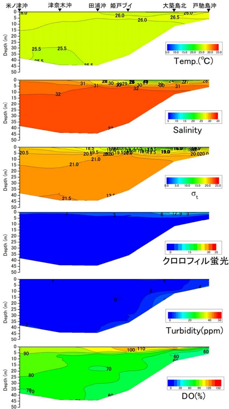
戸馳島沖から米ノ津沖の水温 (°C)、塩分、密度 ( $\sigma_t$ )、クロロフィル蛍光強度、濁度、溶存酸素飽和度 (DO%) の鉛直面図 (熊本県水産研究センターの調査による) (2019年8月27日)
