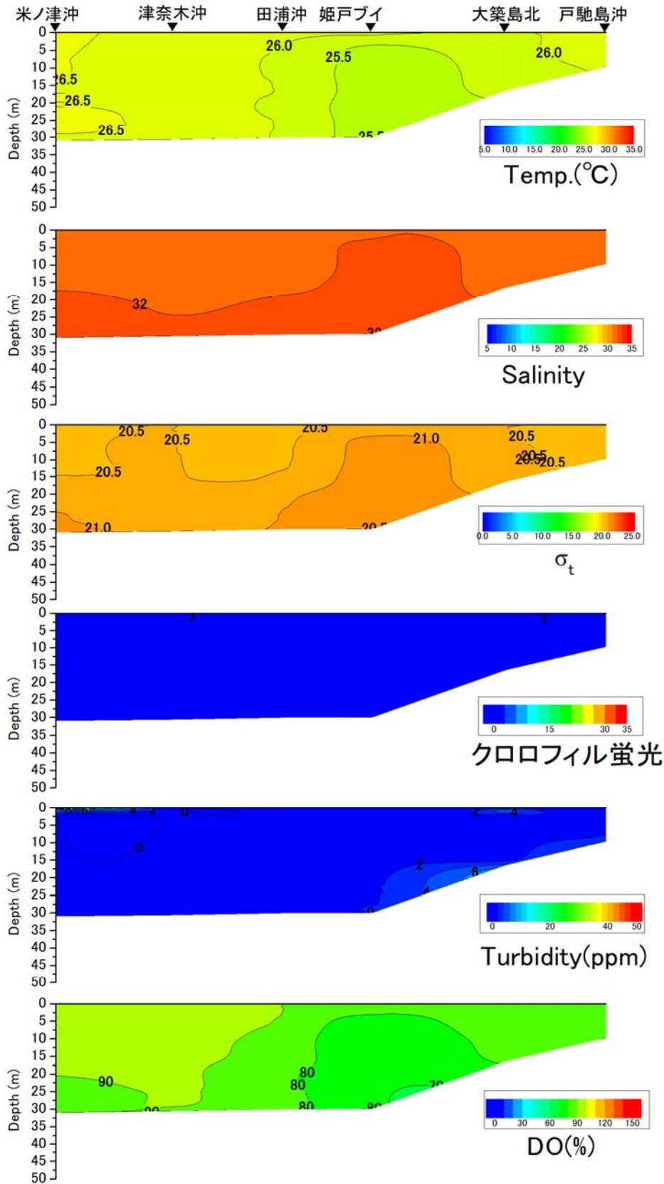
戸馳島沖から米ノ津沖の水温 (°C)、塩分、密度 ( $\sigma_t$ )、クロロフィル蛍光強度、濁度、溶存酸素飽和度 (DO%) の鉛直面図 (東町漁業協同組合の調査による) (2019年8月16日)
