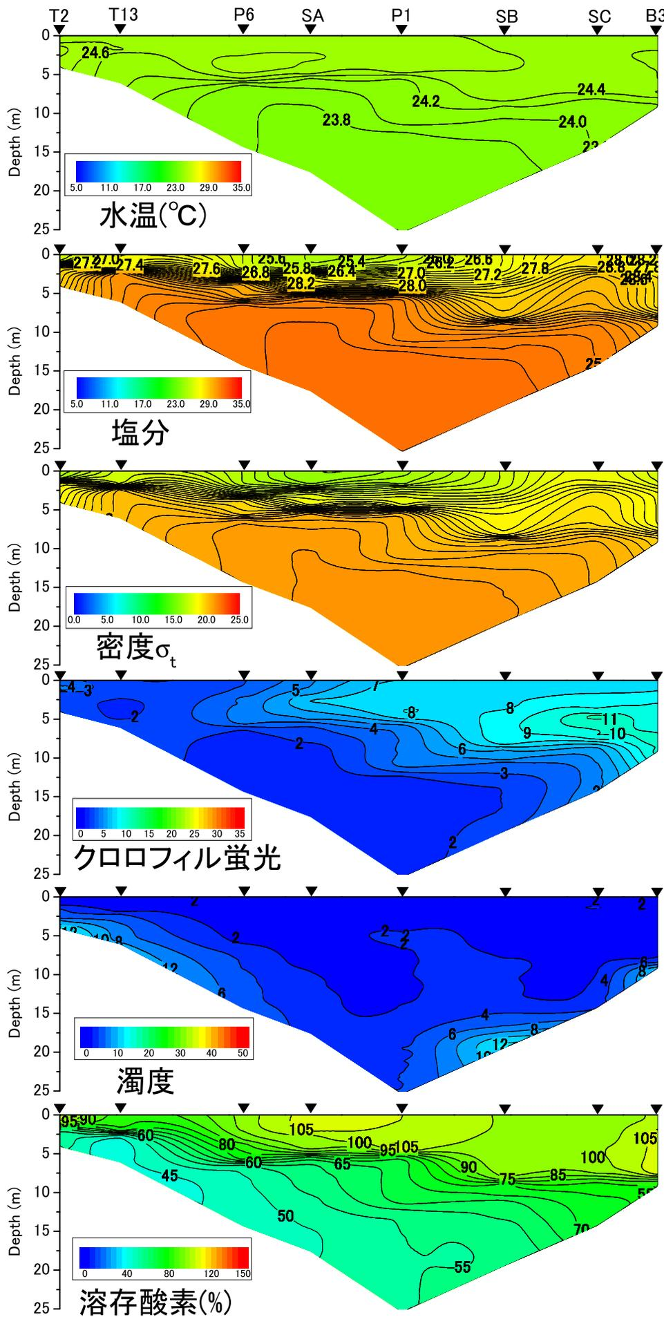
2019年7月15日における水温、塩分、密度 $\sigma_t$ 、クロロフィル蛍光、濁度、溶存酸素(%)
