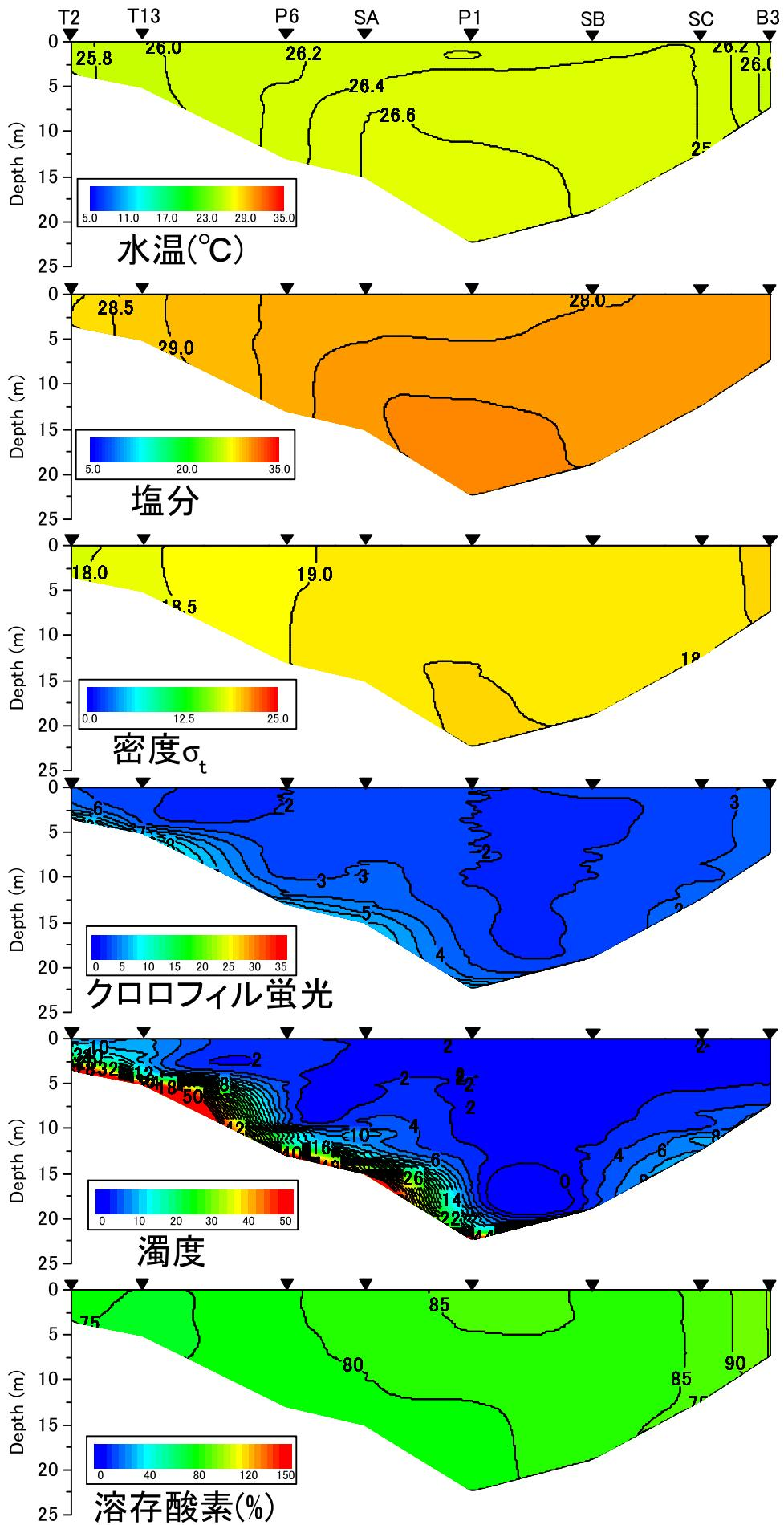
2018年9月12日における水温、塩分、密度  $\sigma_t$ 、クロロフィル蛍光、濁度、溶存酸素(%)
