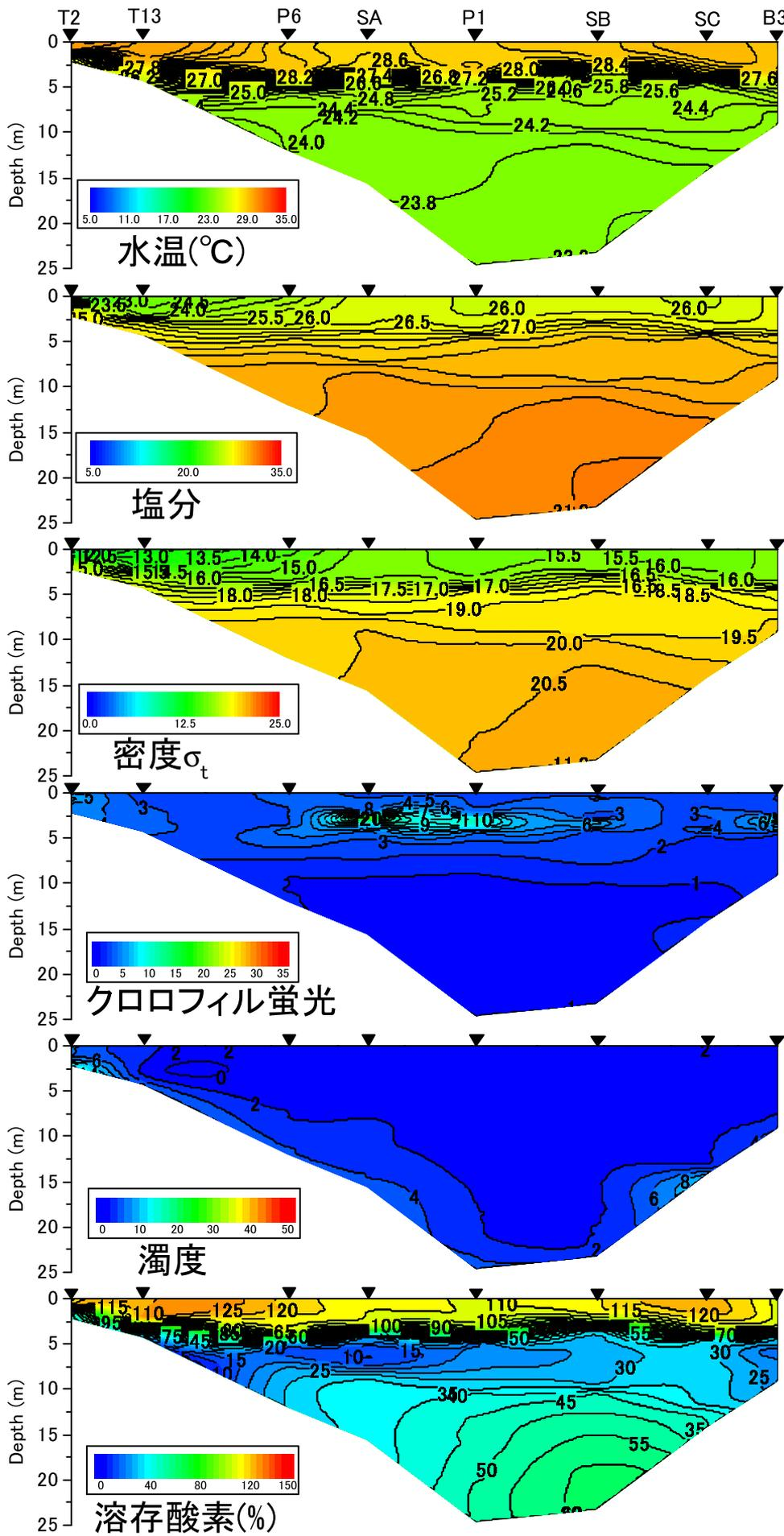
2018年7月23日における水温、塩分、密度 $\sigma_t$ 、クロロフィル蛍光、濁度、溶存酸素(%)
